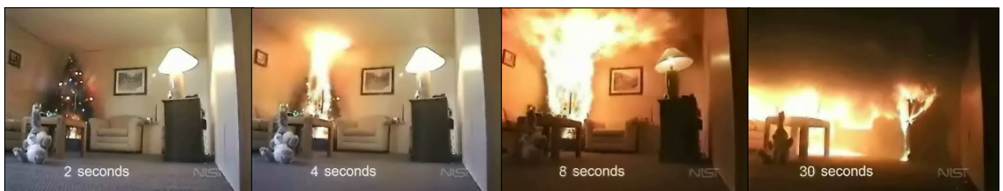
Ein Test zeigt: Ein dürrer Weihnachtsbaum entzündet sich innerhalb von nur 4 Sekunden, nach insgesamt 30 Sekunden steht der ganze Raum in Vollbrand!
