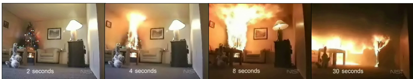
Ein Test zeigt: Ein dürreer Weihnachtsbaum entzündet sich innerhalb von nur 4 Sekunden, nach insgesamt 30 Sekunden steht der ganze Raum in Vollbrand!
