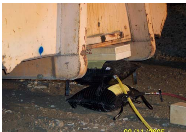
Arbeiten mit den Hebekissen
